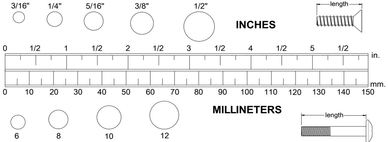
**AVISO:** La longitud de todos los pernos y tornillos, excepto los de cabeza plana, se mide desde abajo de la cabeza hasta el extremo del perno o tornillo. Los pernos y tornillos de cabeza plana se miden desde la parte superior de la cabeza hasta el extremo del perno o tornillo.
